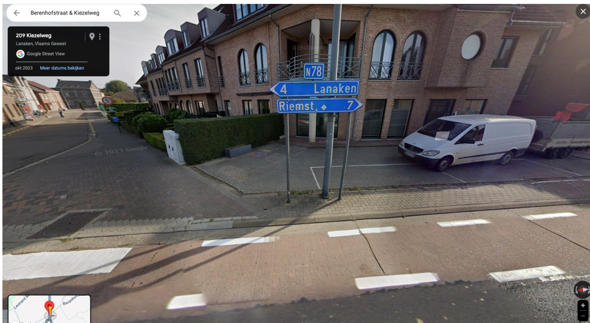
Figuur 32: aanwezigheid verkeersborden en verlichtingspaal die doorgang voetpad hinderen
