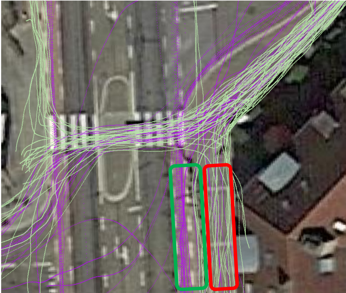
Figuur 16: Combinatie van de trajecten van voetgangers (en een minderheid aan fietsers) uit de ochtend- en namiddagobservatie. De groene rechthoek duidt de voorziene plaats voor voetgangers en fietsers, de rode rechthoek de daadwerkelijke plaats waar zij zich verplaatsen.
