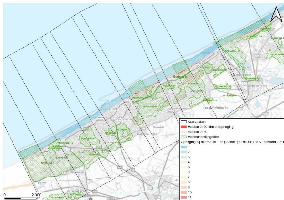
Figuur 7-41: Ophoging binnen alternatief 'Ter plaatse' ter hoogte van wandelende duinen met Helmgras (habitattype 2120) tussen de Westhoek en De Panne bij +1m zeespiegelstijging (links) en +3m zeespiegelstijging (rechts)
