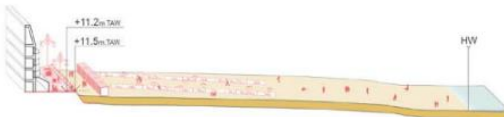
Figuur 7-93: Voorbeelduitwerking De Haan met stormmuurtje en strandsuppleties voor +2 m zeespiegelstijging.
