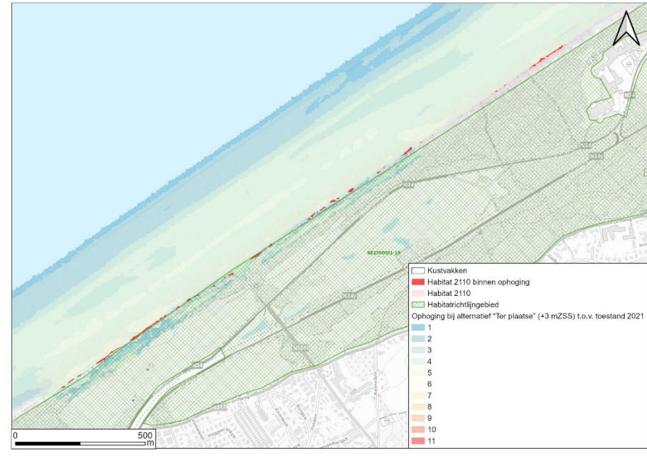
Figuur 7-59: Ophoging binnen alternatief 'Ter plaatse' ter hoogte van embryonale duinen (habitattype 2110) ter hoogte van De Haan bij +1m zeespiegelstijging (links) en +3 m zeespiegelstijging (rechts)
