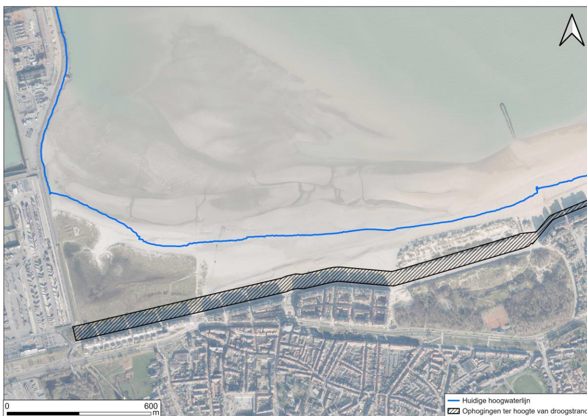
Figuur 7-72: Inname droogstrand ter hoogte van Baai van Heist en duinen van Heist bij alternatief 'Ter plaatse'
