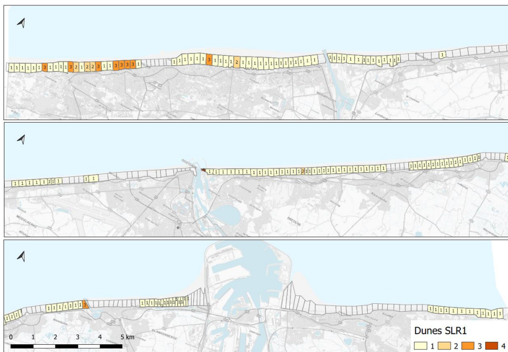
Figuur 6-9: Overzicht van de randvoorwaarden voor duinen bij +1m zeespiegelstijging en de 1000-jarige storm. Cat 1: veilige duin (geen bres). Cat 2: bres omwille van lage vrijboord. Cat 3: bres omwille van duinvolume (duin-ratio). Cat 4: bres omwille van vrijboord en duin-ratio (Consortium Hoogtij(d) (IMDC, ORG, Arcadis), 2022a)
