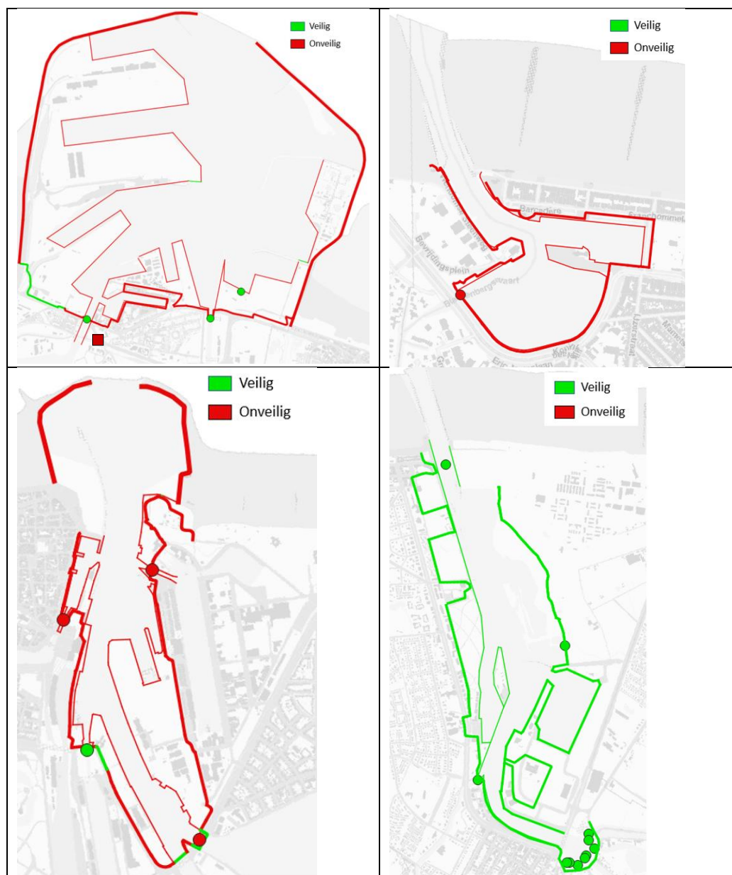
Figuur 6-11: Overzicht van de resultaten veiligheidsscan bij +1 m zeespiegelstijging en de 1000-jarige storm als indicatie waar overstroming van het havengebied optreedt. Rode kleur geeft ter hoogte van structuren falen aan, ter hoogte van de waterkant een maximum debiet > 50 l/m/s en ter hoogte van de zeewering een debiet > 1 l/m/s (Consortium Hoogtij(d) (IMDC, ORG, Arcadis), 2022a)
