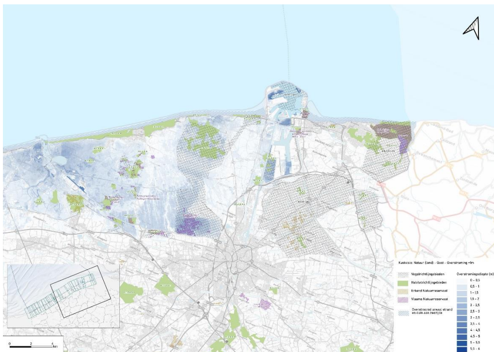
Figuur 6-95: Overstromingen ter hoogte van natuurgebieden aan de Oostkust bij een 1000-jarige storm bij nulalternatief: scenario +1 m zeespiegelstijging (1)
