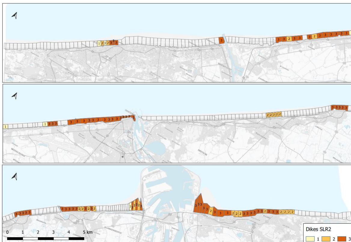
Figuur 6-14: Overzicht van de randvoorwaarden voor dijken bij +2 m zeespiegelstijging en de 1000-jarige storm. Cat 1: veilige dijk. Cat 2: overslag (< 100 l/m/s). Cat 3: falen van dijk (overslag > 100 l/m/s of overflow) (Consortium Hoogtij(d) (IMDC, ORG, Arcadis), 2022a)
