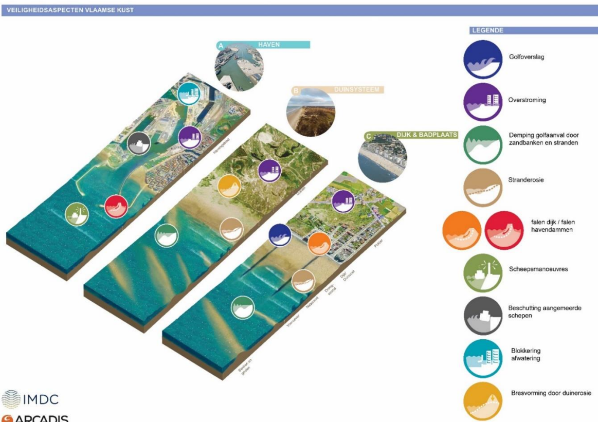
Figuur 6-8: Overzicht van de kusttypologieën aan de Vlaamse kust, en de bijhorende veiligheidsrisico's (Consortium Hoogtij(d) (IMDC, ORG, Arcadis), 2022c) Overstromingsrisico
