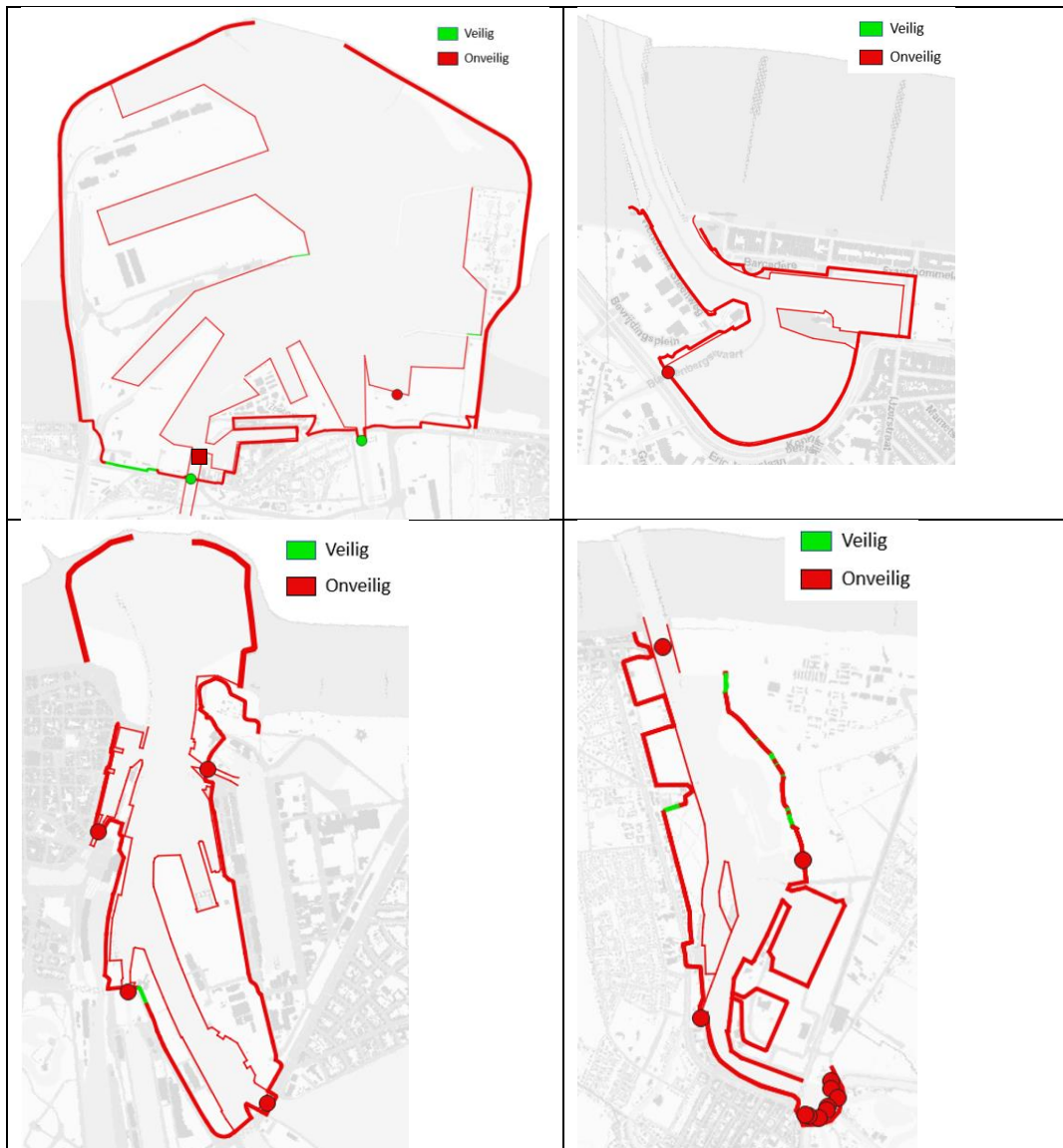
Figuur 6-15: Overzicht van de resultaten veiligheidsscan bij +2m zeespiegelstijging en de 1000-jarige storm als indicatie waar overstroming van het havengebied optreedt. Rode kleur geeft ter hoogte van structuren (bollen) falen aan, ter hoogte van de waterkant (dunne lijn) een maximum debiet > 50 l/m/s en ter hoogte van de zeewering (dikke lijn) een debiet > 1 l/m/s (Consortium Hoogtij(d) (IMDC, ORG, Arcadis), 2022a)
