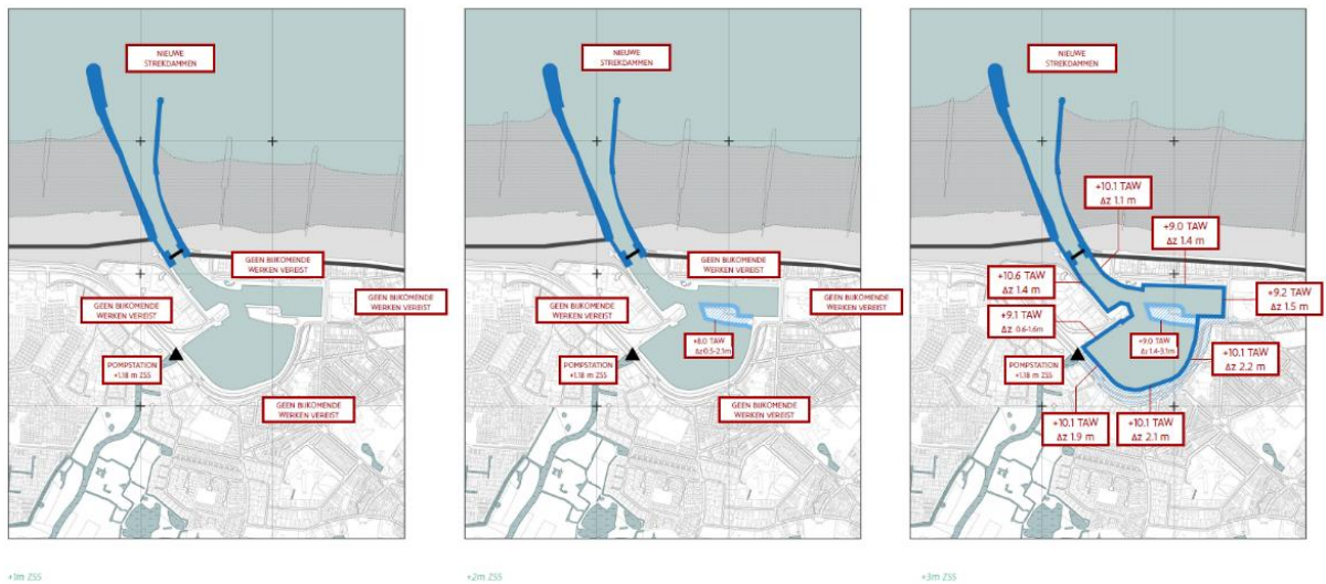
Figuur 2-47: Indicatieve hoogte van de maatregelen t.o.v. het huidige terrein voor het alternatief 'Stormvloedkering in de havenmond' van Blankenberge. De lichtblauwe zones liggen voor de primaire zeekering en worden verhoogd om niet onder water te lopen bij hoog water springtij. De ingetekende verlenging van de strekdammen toont de aansluiting op het alternatief 'Zeewaarts'.
