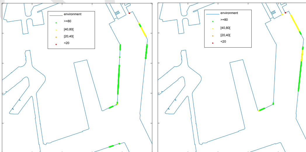
Figuur 28 - Simulatie 38 - Minimale afstanden tot kaai – Links: invarend; Rechts: uitvarend
