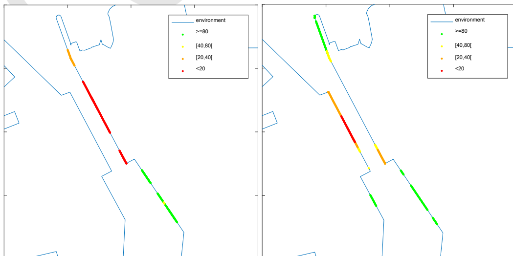
Figuur 30 - Simulatie 39 - Minimale afstanden tot kaai – Links: uitvarend; Rechts: invarend
