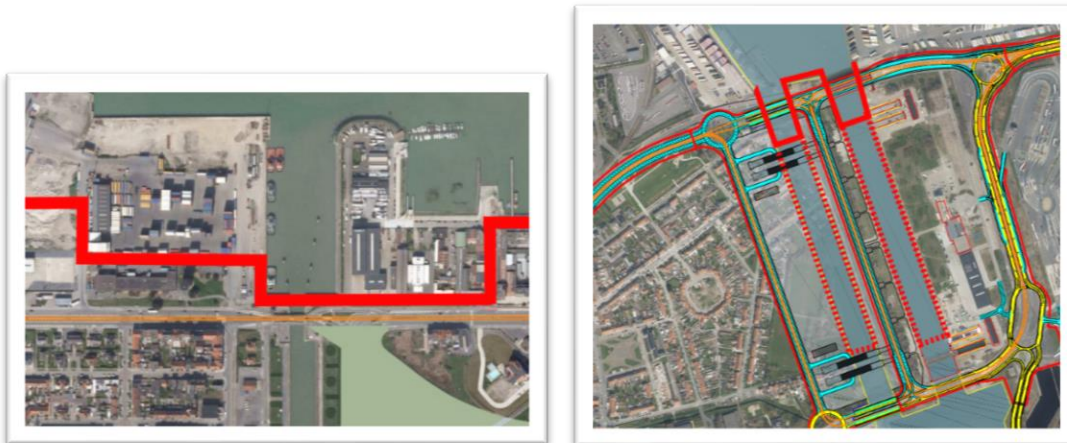
Figuur 5.19: Contouren maatregelen tegen overstroming (links: t.h.v. Visartsluis – rechts t.h.v. Vandammesluis en nieuwe zeesluis) (Tractebel, 2016 k)
