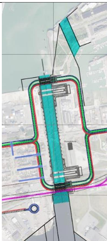
Figuur 5.5: Visualisatie ligging van de zee- en landwaartse deurkamers aan oostelijke zijde in het basisalternatief (linkse figuur) en zeewaartse deurkamer aan westelijke zijde en landwaartse deurkamer aan oostelijke zijde bij de ligging van
