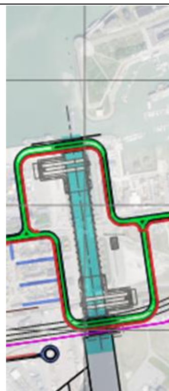
Figuur 5.5: Visualisatie ligging van de zee- en landwaartse deurkamers aan oostelijke zijde in het basisalternatief (linkse figuur) en zeewaartse deurkamer aan westelijke zijde en landwaartse deurkamer aan oostelijke zijde bij de ligging van
