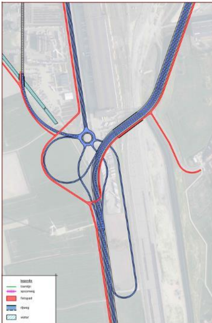
Figuur 5.18 : Alternatief parallelle ontsluiting haven – deel zuid
