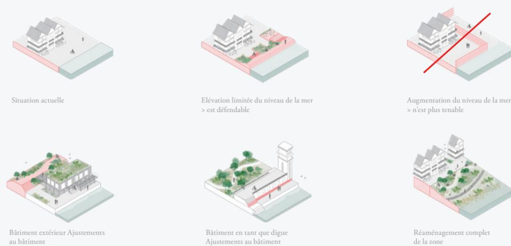
Figure 1-6 : Exemples d'intégration possible de mesures de protection côtière dans l'espace en cordon.
