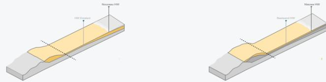
Figure 1-14: Principe de l'élévation progressive des dunes et de la création d'une plage sèche plus large au niveau des zones dunaires pour l'alternative "Vers le large - en une fois". La ligne des hautes eaux est indiquée sur les figures par HW.
