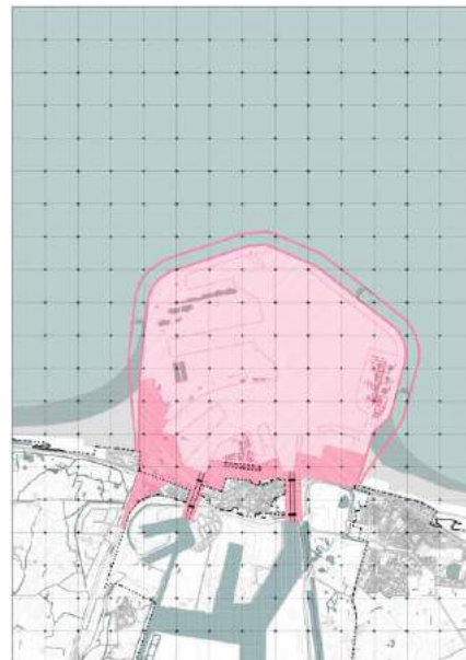
Fig. 10-24 Kustbeschermings zoekzone met ontwerpcontour stormvloedkering met inkomende vloedscherm en aardse afsluiting. Schuifwijdte naar buitengebied = 100 m, naar kustlijn = 100 m.
