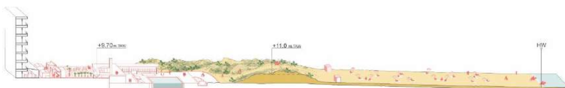
Fig. 7-96: Overheidsaanpak op de strand- en duingebieden van de kust van de stad van Oostduinkerke tot de dijk bij +11 m zeespiegelstijging
