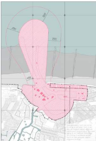
Fig. 10-23 Kustbeschermings zoekzone met ontwerpcontour stormvloedkering met inkomende vloedscherm en aardse afsluiting. Schuifwijdte naar buitengebied = 100 m, naar kustlijn = 100 m.
