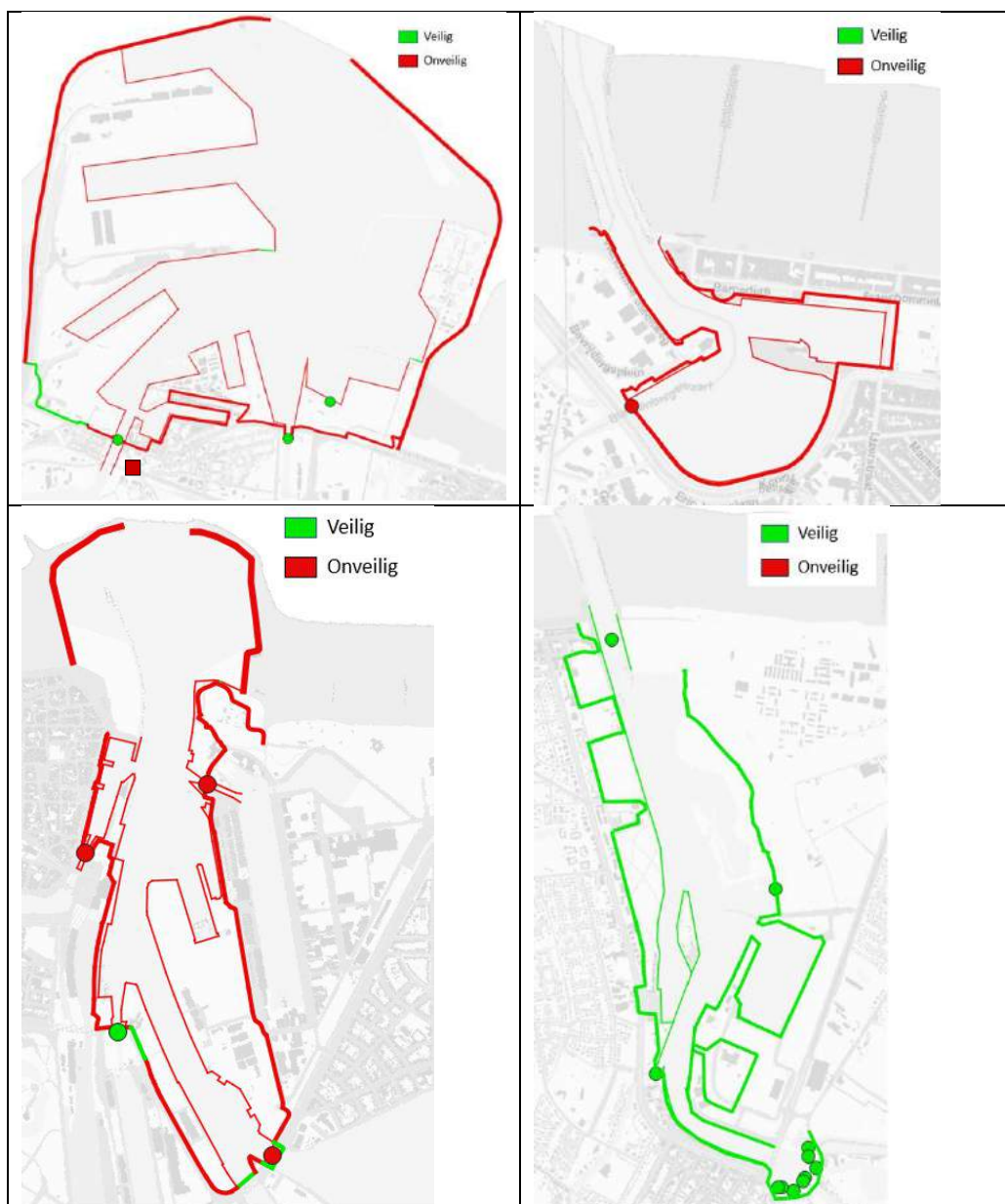
Figuur 6-11: Veiligheidsstatus van de havens bij een zeespiegelstijging van +1 m bij een 1000-jarige storm. De rode kleur geeft aan of de structuren falen. De groene kleur geeft aan of de structuren veilig zijn. De rode vierkant geeft aan of de structuren falen bij +1 m zeespiegelstijging. De groene vierkant geeft aan of de structuren veilig zijn bij +1 m zeespiegelstijging. De rode vierkant geeft aan of de structuren falen bij +1 m zeespiegelstijging. De groene vierkant geeft aan of de structuren veilig zijn bij +1 m zeespiegelstijging.
