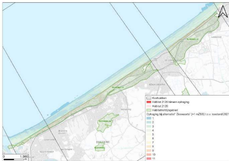
Fig. 7-71: a) de hoogte van de alternatieve kustlijn bij een ophoging van de kust van de gemeente Bredene met maximaal 1 mZSS t.o.v. de toestand in 2021; b) de ophoging van de kust van de gemeente Steenvoer met maximaal 3 mZSS t.o.v. de toestand in 2021
