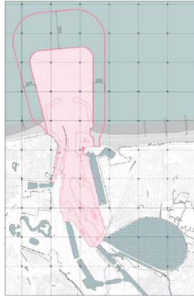
Fig. 10-22 Kustbeschermings zoekzone met ontwerpcontour stormvloedkering met inkomende vloedscherm en aardse afsluiting. Schuifwijdte naar buitengebied = 100 m, naar kustlijn = 100 m.
