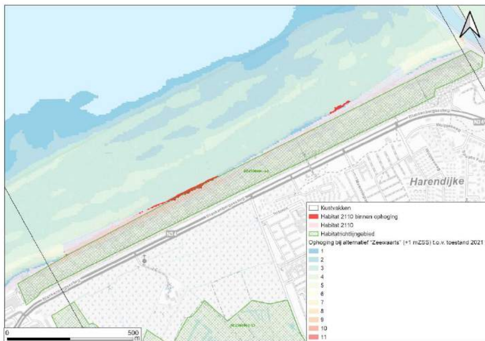
Fig. 7-4: Ophoging van kustvakken 'Zeewaarts' – de structuur van de ophoging van de kustvakken 2110 tuss. de dijk en de strandwal van de Harendijke (links) en de Wenduine (rechts) bij alternatief 'Zeewaarts'.
