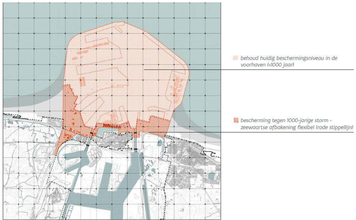
Figuur 2-65: Behoud huidig beschermingsniveau in de open voorhaven met het beschermingslint voor de jachthaven van Zeebrugge. Het donkeroranje zone verschilt per alternatief voor de jachthaven van Zeebrugge.
