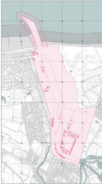
Fig. 10-21 Kustbeschermings zoekzone met ontwerpcontour stormvloedkering met inkomende vloedscherm en aardse afsluiting. Schuifwijdte naar buitengebied = 100 m, naar kustlijn = 100 m.
