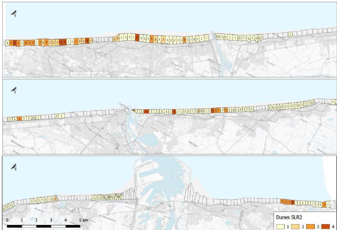
Figuur 6-13 Map van de randvoorwaarden voor de overstromingsberekeningen voor een 1000-jarige storm van de duinsecties bij +2 m zeespiegelstijging. (Consortium Hoogtij(d) (IMDC, ORG, Arcadis), 2022a)
