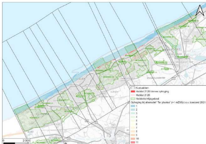
Fig. 7-11: Ophoging van de kustvakken bij alternatief 'Zeevaarts' – de ophoging van de kustvakken is gebaseerd op de ophoging van de kustvakken bij alternatief 'Ter plaatse' (+1 mZSS) t.o.v. toestand 2021. De ophoging van de kustvakken is gebaseerd op de ophoging van de kustvakken bij alternatief 'Ter plaatse' (+1 mZSS) t.o.v. toestand 2021.
