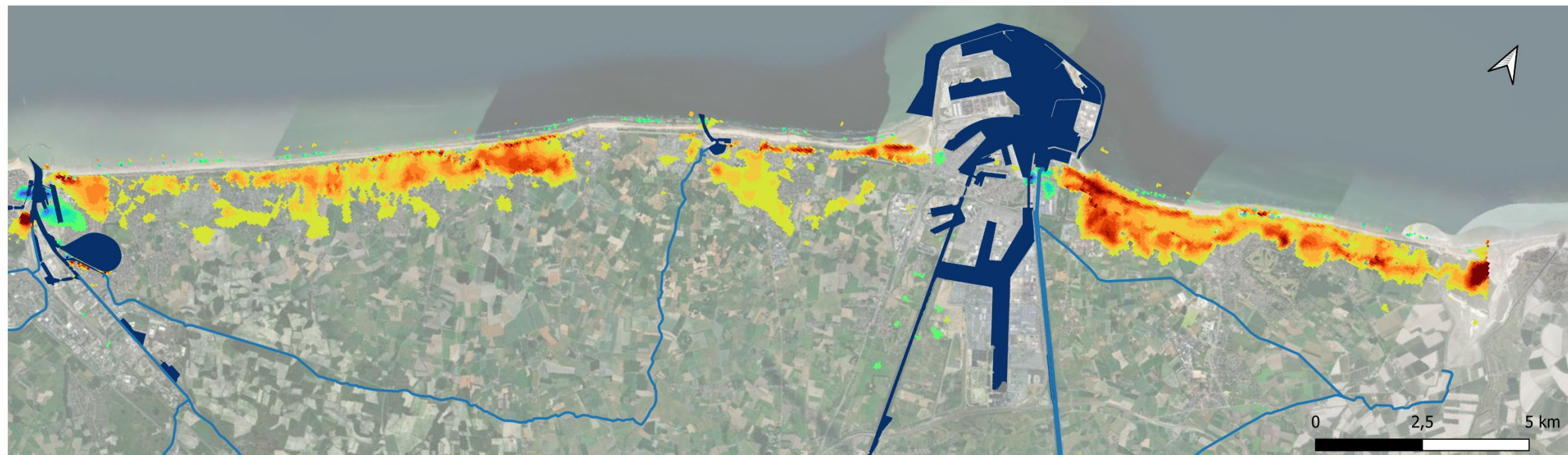
Figuur bijlage C-4: Verschilkaart van de diepte zoutfront anno 2125 met zeewaartse stranduitbreiding en met zeespiegelstijging tov diepte zoutfront anno 2125 zonder zeewaartse stranduitbreiding en met zeespiegelstijging
