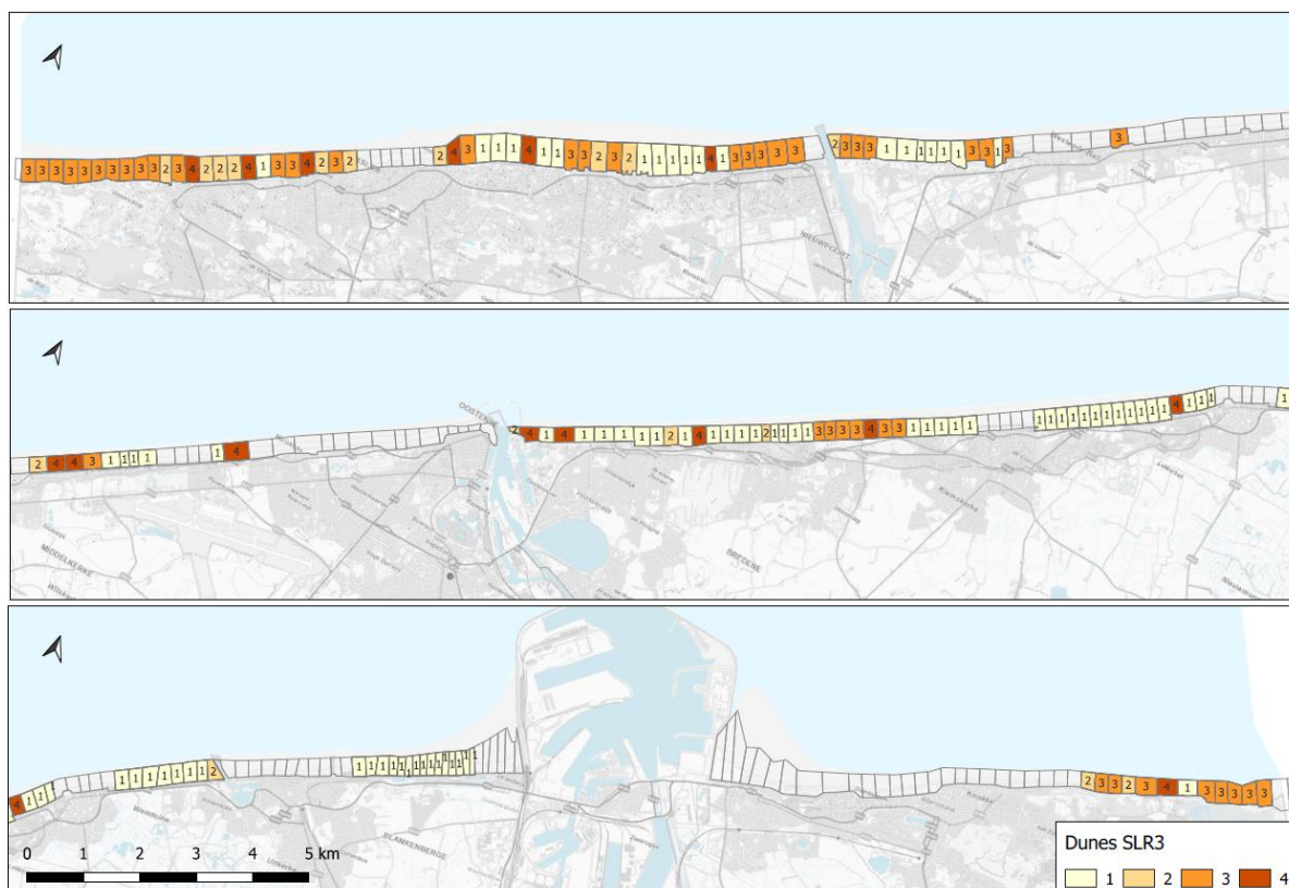
Figuur 3-19 : Overzicht van de randvoorwaarden voor duinen bij +3 m zeespiegelstijging. Cat 1: veilige duin (geen bres). Cat 2: bres omwille van lage vrijboord. Cat 3: bres omwille van duinvolume (duin-ratio). Cat 4: bres omwille van vrijboord en duin-ratio.
