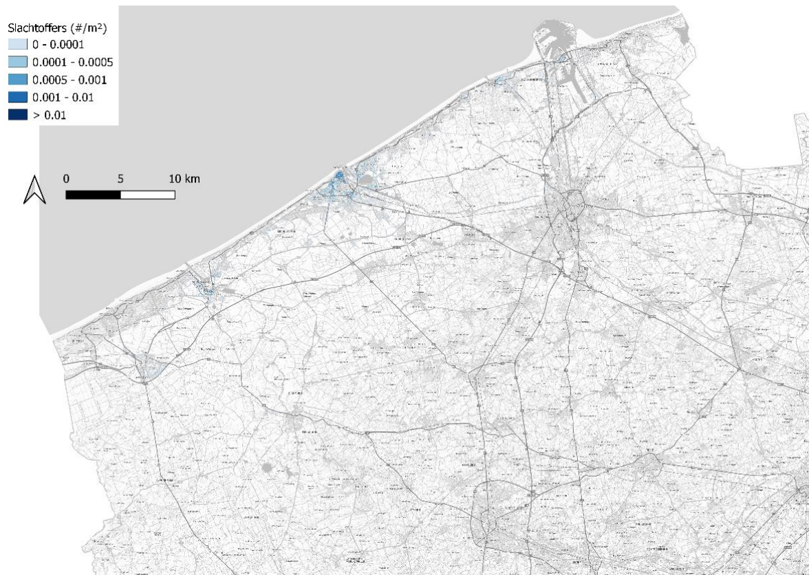
Figuur 3-18: Slachtoffers in de kustvlakte bij +2 m zeespiegelstijging (scenario ZSS2).
