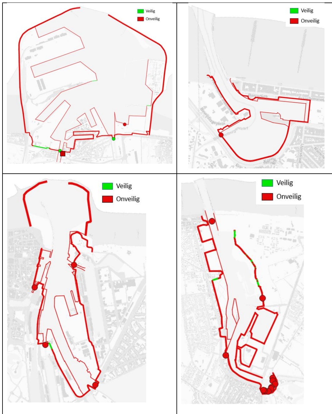
Figuur 3-12: Overzicht van de resultaten veiligheidsscan bij +2 m zeespiegelstijging als indicatie waar overstroming van het havengebied optreedt. Rode kleur geeft ter hoogte van structuren (bollen) falen aan, ter hoogte van de waterkant (dunne lijn) een maximum debiet > 50 l/m/s en ter hoogte van de zeewering (dikke lijn) een debiet > 1 l/m/s.
