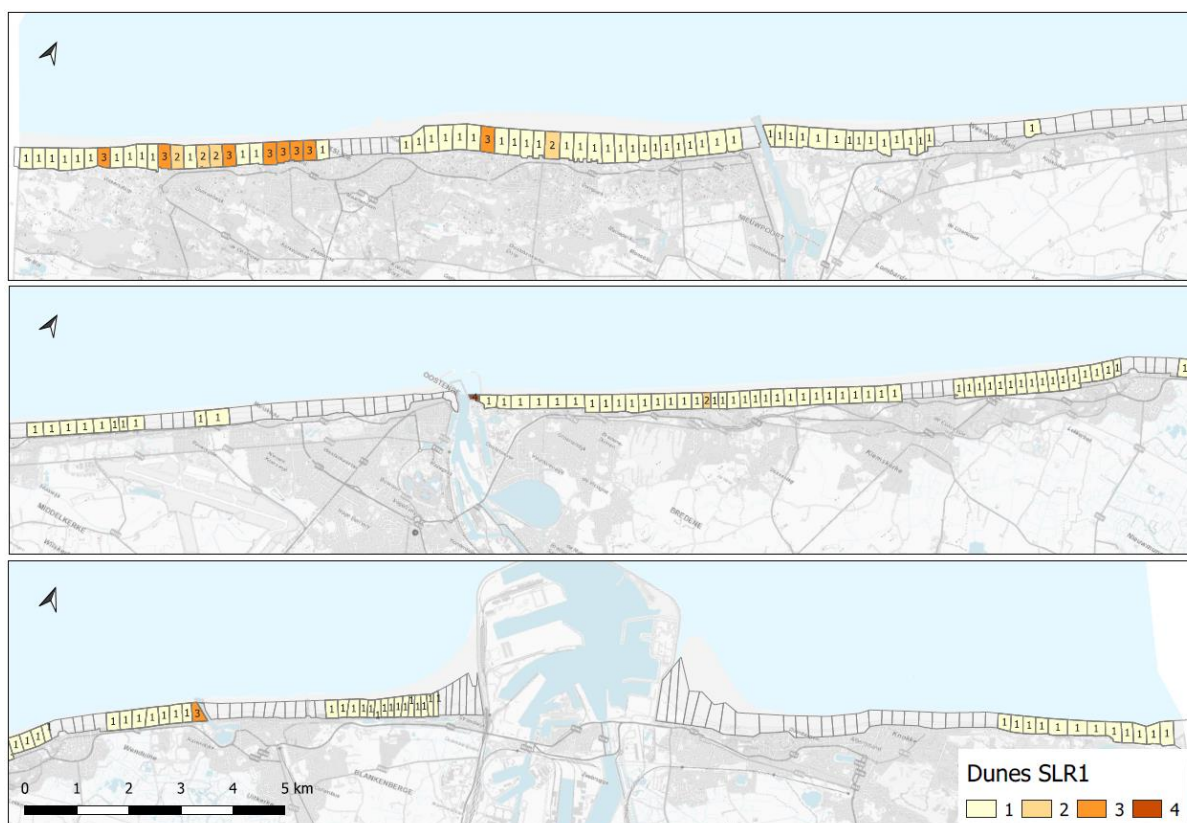
Figuur 3-1: Overzicht van de randvoorwaarden voor duinen bij +1 m zeespiegelstijging. Cat. 1: veilige duin (geen bres). Cat. 2: bres omwille van lage vrijboord. Cat. 3: bres omwille van duinvolume (duin-ratio). Cat. 4: bres omwille van vrijboord en duin-ratio.
