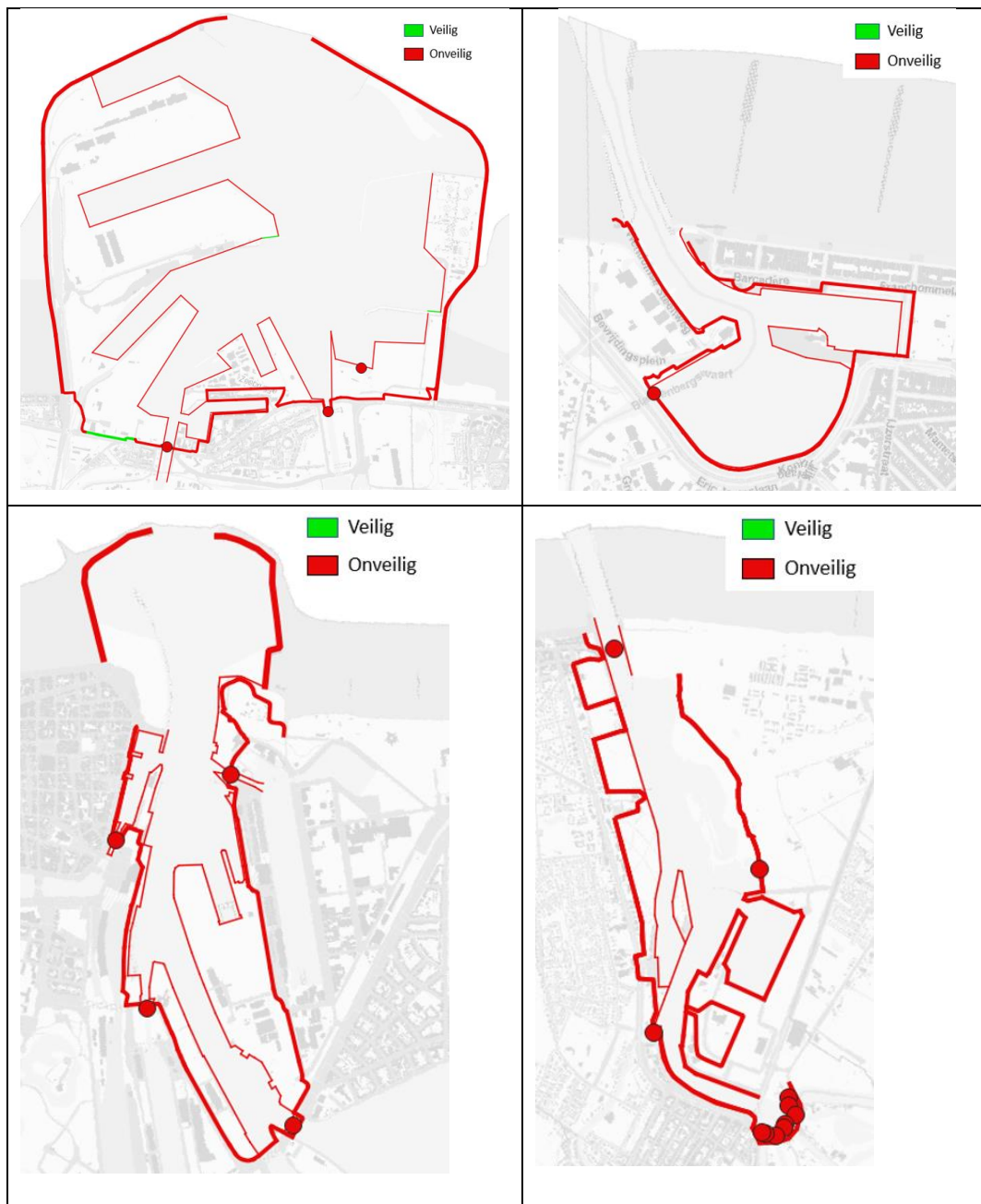
Figuur 3-21: Overzicht van de resultaten veiligheidsscan bij +3 m zeespiegelstijging als indicatie waar overstroming van het havengebied optreedt. Rode kleur geeft ter hoogte van structuren (bollen) falen aan, ter hoogte van de waterkant (dunne lijn) een maximum debiet > 50 l/m/s en ter hoogte van de zeewering (dikke lijn) een debiet > 1 l/m/s.
