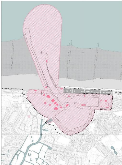
Figuur 5-34: Beschermingslint (de roze gearceerde zone) van het redelijk alternatief in de haven van Blankenberg bij een bescherming met stormvloedkering met uitgestelde keuze voor de sprong naar stormvloedkering, sluis of open sluis na +2 m zeespiegelstijging. Bron: Onderzoeksnota Strategisch Beleidsplan (Consortium Hoogtij(d) (IMDC, ORG, Arcadis), 2023).
