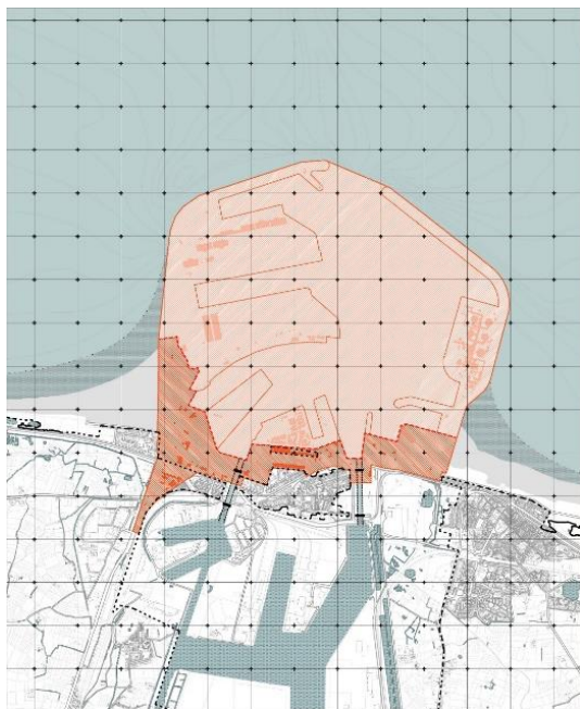
Figuur 5-37: Beschermingslint (de oranje gearceerde zone) van het redelijk alternatief in de haven van Zeebrugge bij een met open voorhaven en stormvloedkering bij de jachthaven (deel voorhaven). Bron: Onderzoeksnota Strategisch Beleidsplan (Consortium Hoogtij(d) (IMDC, ORG, Arcadis), 2023).
