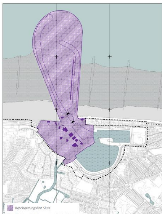
Figuur 5-32: Beschermingslint (de paars gearceerde zone) van het alternatief in de haven van Blankenberge bij een bescherming met stormvloedkering met sprong naar sluis na +2 m zeespiegelstijging. Bron: Onderzoeksnota Strategisch Beleidsplan (Consortium Hoogtij(d) (IMDC, ORG, Arcadis), 2023).
