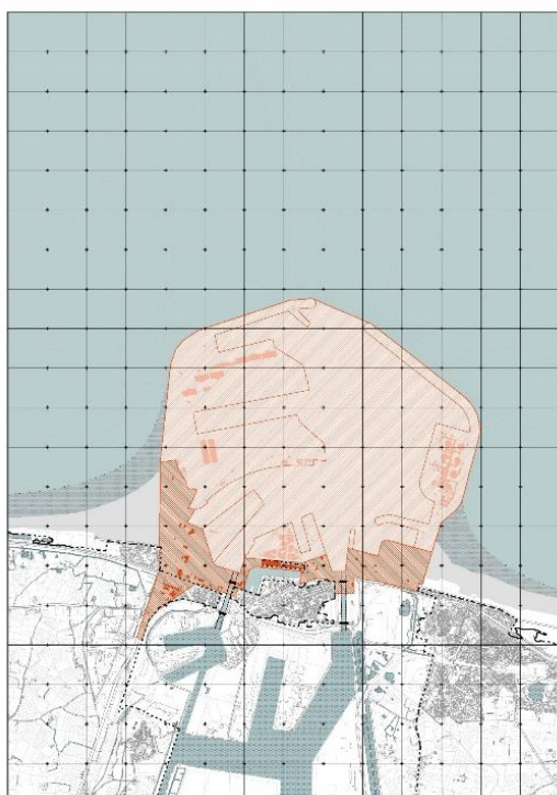
Figuur 5-40: Beschermingslint (de oranje gearceerde zone) van het redelijk alternatief in de haven van Zeebrugge met een open voorhaven en een sluis bij de jachthaven. Bron: Onderzoeksnota Strategisch Beleidsplan (Consortium Hoogtij(d) (IMDC, ORG, Arcadis), 2023).
