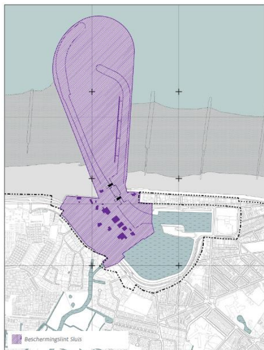
Figuur 5-33: Beschermslint (de paars gearceerde zone) van het alternatief in de haven van Blankenberge bij een bescherming met een sluis. Bron: Onderzoeksnota Strategisch Beleidsplan (Consortium Hoogtj(d) (IMDC, ORG, Arcadis), 2023).
