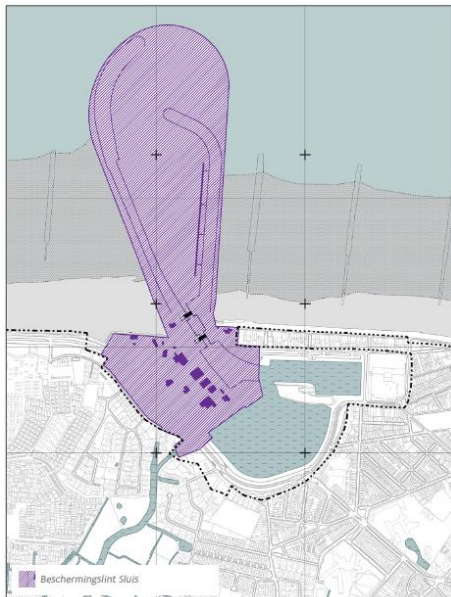
Figuur 3-27: Beschermingslint (de paars gearceerde zone) van het alternatief 'Stormvloedkering met sprong naar sluis na +2 m zeespiegelstijging' in de haven van Blankenberge.
