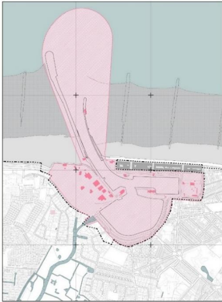
Figuur 3-33: Beschermingslint (de roze gearceerde zone) van het alternatief 'Stormvloedkering met uitgestelde keuze voor de sprong naar stormvloedkering, sluis of open sluis na +2 m zeespiegelstijging' in de haven van Blankenberge.
