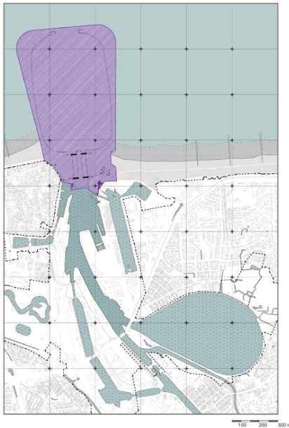
Figuur 3-17: Beschermingslint (paars gearceerde zone) van het alternatief met de 'Sluis' in de haven van Oostende. Hierbij zijn zeer lange nieuwe havendammen nodig.
