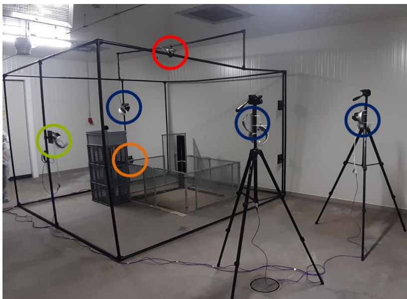
Figuur 4: Stalen kooi met afmetingen 3m x 3m x 2m voor het filmen van de vleeskuikens. Vier infraroodcamera's werden op de kooi geplaatst en twee infraroodcamera's op statieven buiten de kooi. Groen = frontaal beeld, Rood = bovenaanzicht, Oranje = beneden zijaanzicht en Blauw = zijaanzicht.
