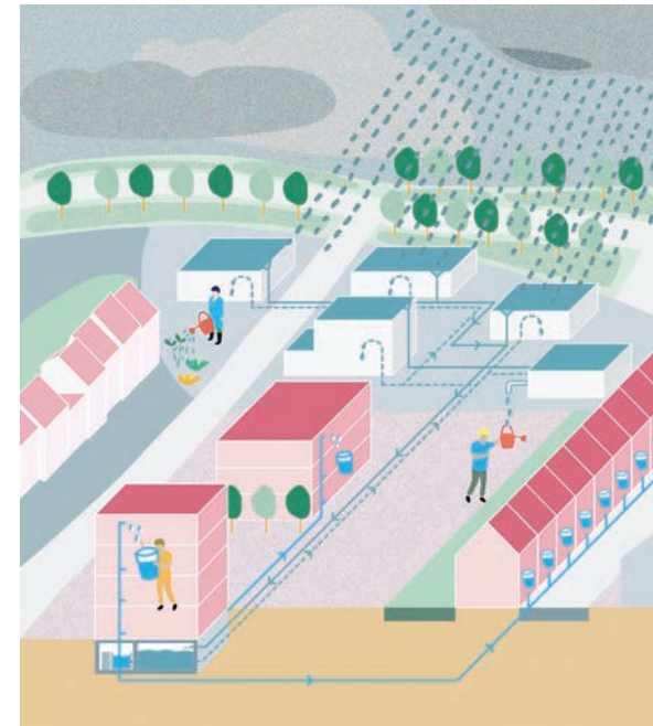
WASCO streeft naar een circulair gebruik van regenwater om wateroverlast tegen te gaan. Het water dat de bedrijven opvangen wordt gebruikt in een nabijgelegen woonwijk. © Architecture Workroom Brussels, Vlaamse Milieumaatschappij
