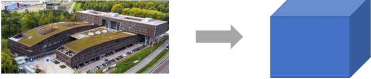
Figuur 4: illustratie van de vereenvoudigde geometrie, complexe vorm van werkelijk gebouw (links) wordt vereenvoudigd naar een kubus.
