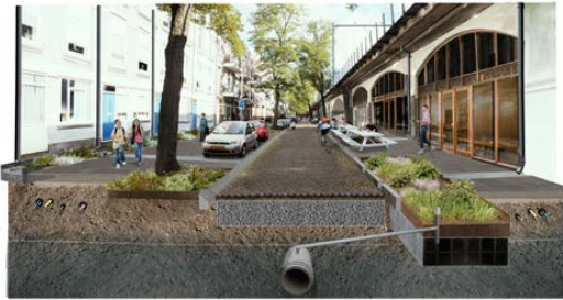
Aantrekkelijke watersensitieve straatinrichting met waterpasserende verharding, bergende wegfundering, onharding rond bomen, geveltuintjes en bioswales met extra bergende kranten.
