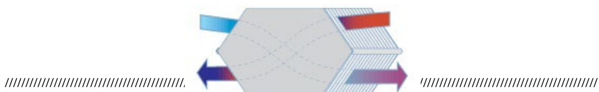
Figuur 5: Principe van warmterecuperatie
