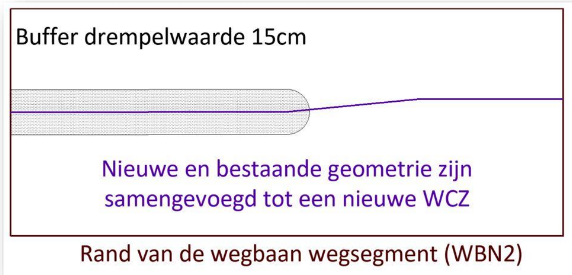
Figuur 37: eindpunt nieuwe WCZ aansluiten op eindpunt bestaande WCZ uit GRBcad
