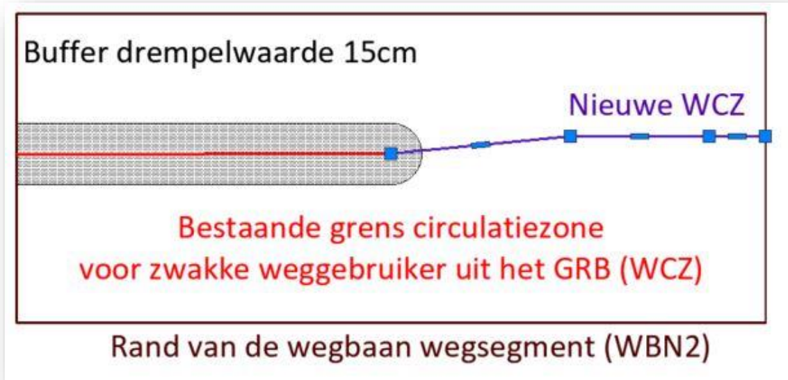
Figuur 37: eindpunt nieuwe WCZ aansluiten op eindpunt bestaande WCZ uit GRBcad
