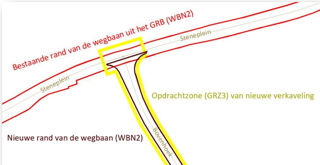
Figuur 28: aansluiting rand van de wegbaan van nieuwe verkaveling op bestaande weg
