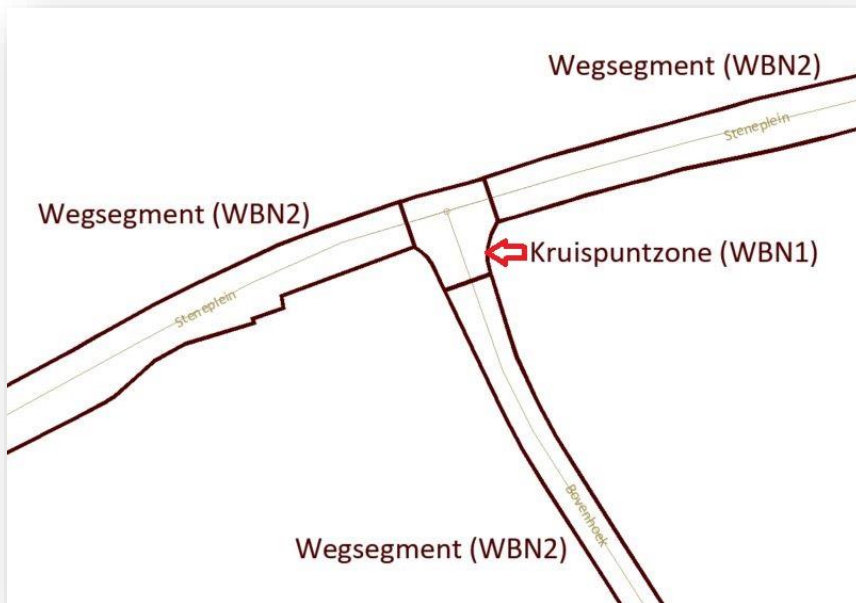
Figuur 28: aansluiting rand van de wegbaan van nieuwe verkaveling op bestaande weg
