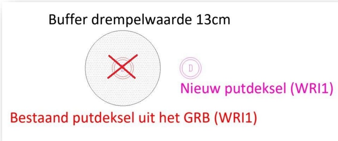
Figuur 23: nieuw putdeksel ligt buiten drempelwaarde van bestaande putdeksel uit GRBcad
