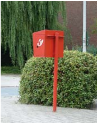
Fig. 2.1.1o Deze brievenbus is van boven veel breder dan op grondniveau tastbaar is. Een dergelijk obstakel hoort op de looproute zeker niet thuis.
