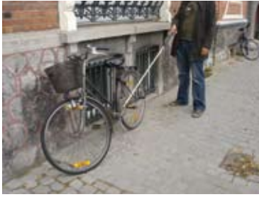
Fig. 2.1.3m (Losse) obstakels verstoren de gidslijn en moeten zoveel mogelijk vermeden worden. Een fietsenstalling buiten de looproutte zou hier een oplossing zijn.
