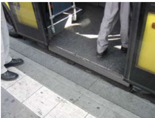
Fig. 2.4.1 g Het hoogteverschil en de opening tussen perron en de vloer van het voertuig moet worden geminimaliseerd.
