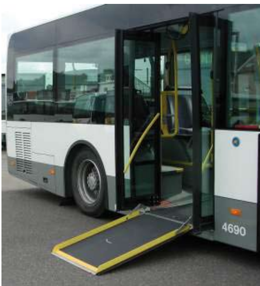
Fig. 2.4.1g Op dit moment is er voor een drempelloze overbrugging van het perron en het voertuig altijd een opstapplank nodig
