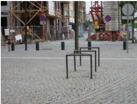
Fig. 3.1f Grote oppervlakken zijn ideaal om met een borstelmachine te worden ontdaan van onkruid. Obstakels worden daarom zo veel mogelijk geclusterd.
