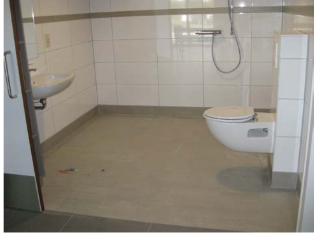
Ruime sanitaire cel met een vlakke douchezone die voldoende groot is voor een douchebrancard. 't Weyerke, © Toegankelijkheidsbureau vzw
