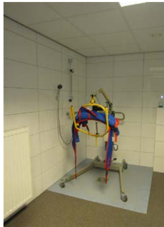
Vlakke douche met verrijdbare tillift. Naast de doucheglijstang is een extra douchekophouder op bereikbare hoogte voor zorgverleners.
