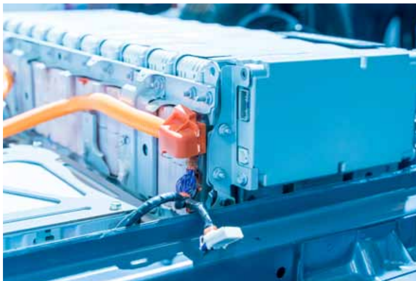
Lithium-ion battery pack met vermogen aansluiting
