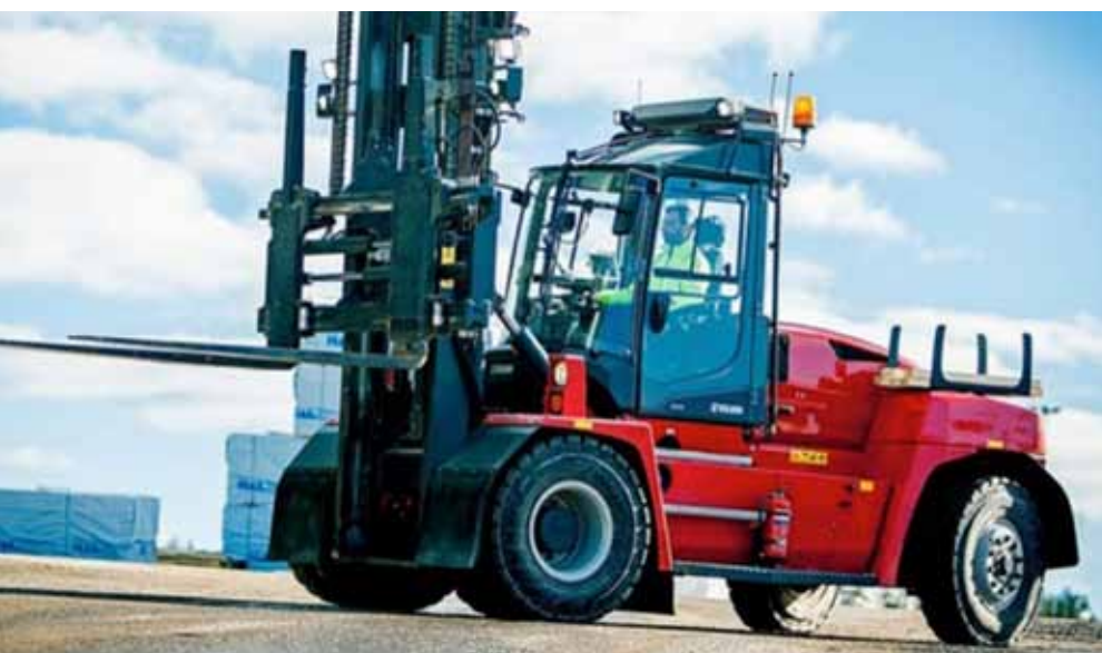
Middelzware elektrische heftruck (16 ton) van Kalmar die een waterstofaandrijving kreeg (bron: Kalmar)
