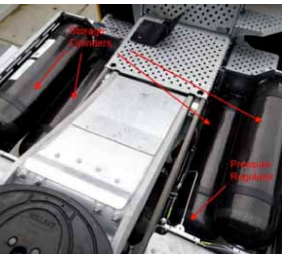
Aanduiding van de waterstoftanks bij de Terberg YT203-H2 (bron: Terberg)
