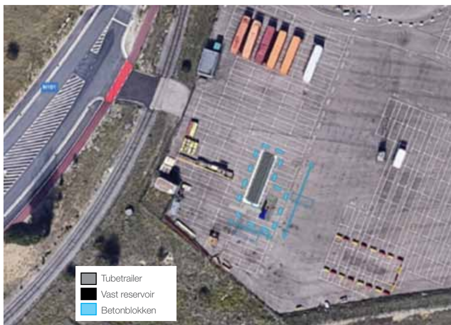
Detail van de beoogde opstelling met tankstation, externe opslag en afsluiting bij PSAA op de Lichterkaai
