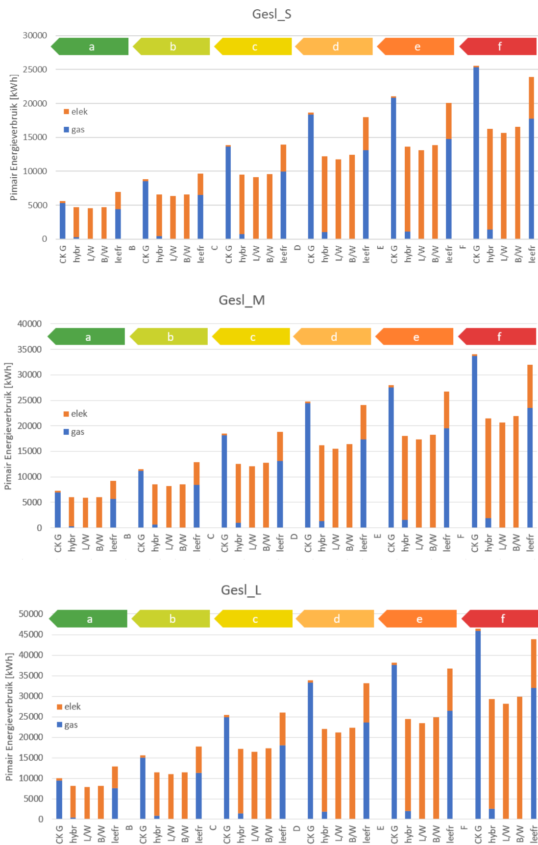
Figuur 48: Primair energieverbruik voor gas en elektriciteit voor de verschillende mogelijke installatie(combinatie)s voor gesloten wooneenheden van verschillende isolatiegraden
