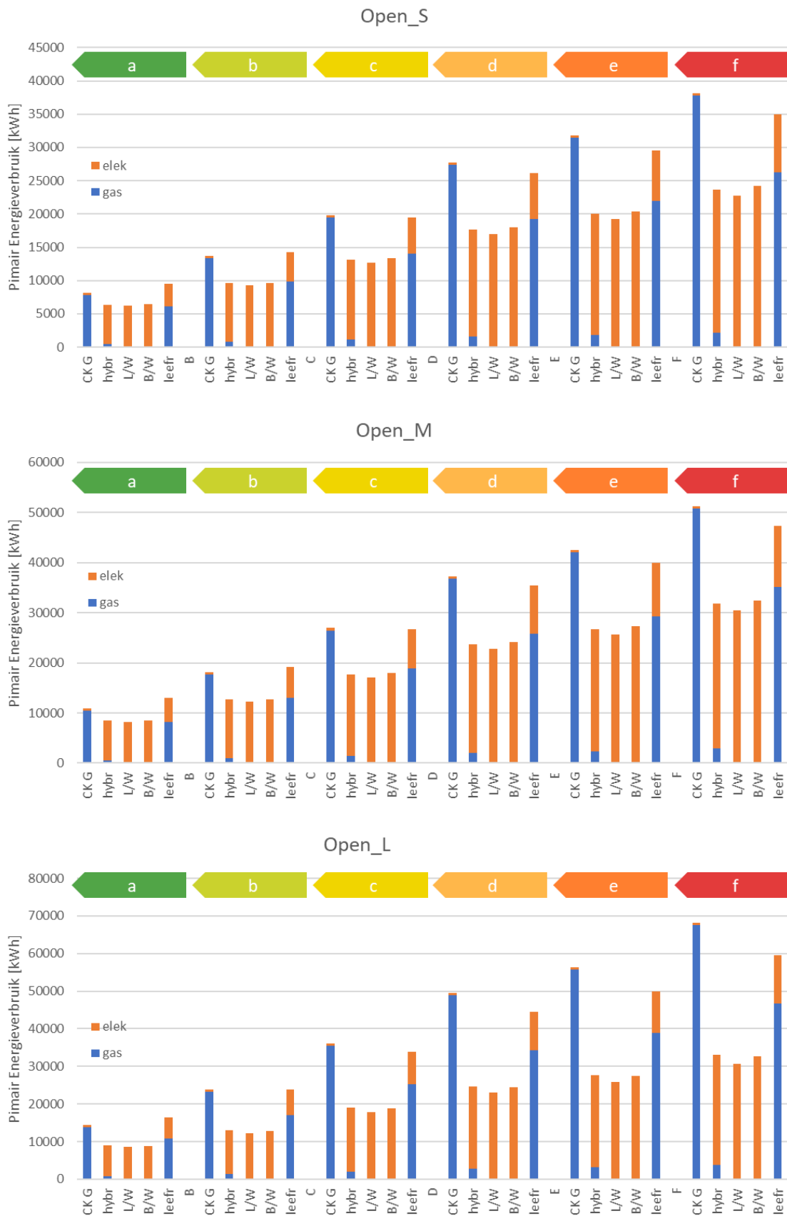
Figuur 50: Primair energieverbruik voor gas en elektriciteit voor de verschillende mogelijke installatie(combinatie)s voor open wooneenheden van verschillende isolatiegraden
