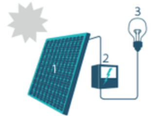
1. Zonnepaneel | 2. Omvormer | 3. Elektrische toestellen
