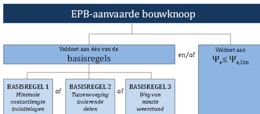
Figuur 6-4: Principeschema voor een EPB-aanvaarde bouwknop 4
