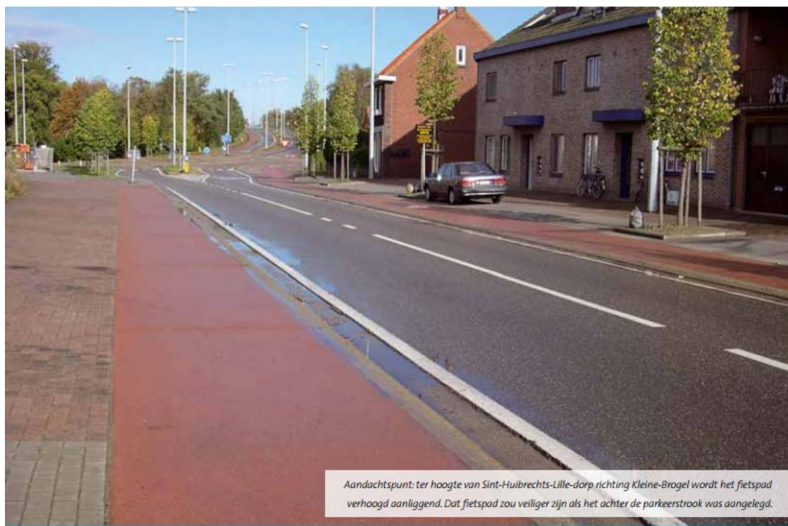
Figuur 12: Voorbeeld van een verhoogd aanliggend fietspad in landelijk gebied - Bron : http://www.mobielvlaanderen.be/vademecums/fiets-praktijkvoorbeelden.pdf
