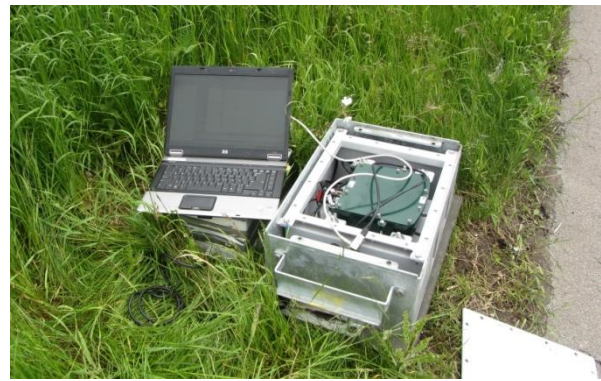
Foto 2: TIRTL in behuizing met batterij; rechts: uitlezen van verzamelde data
