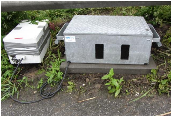
Foto 2: TIRTL in behuizing met batterij; rechts: uitlezen van verzamelde data
