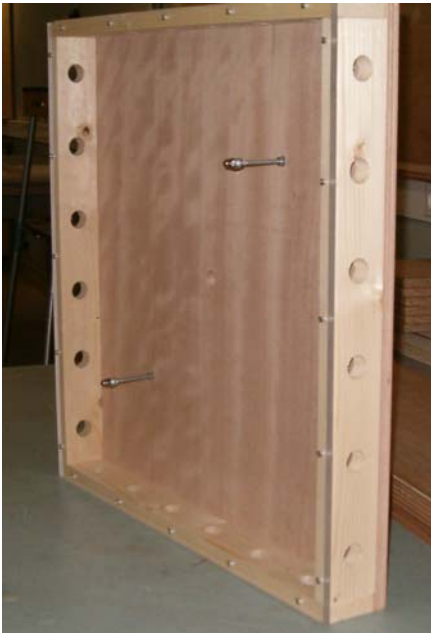
Fig. 2a: Testbox 60x60x6 cm 3 voor vulling
