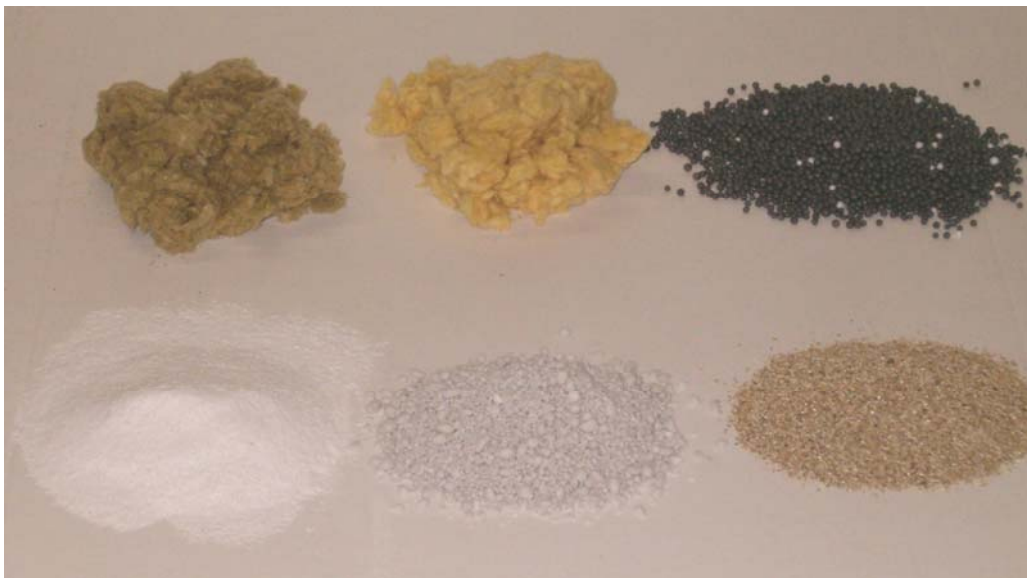
Figuur 1: Verzamelde grondstoffen voor na-isolatie Bovenste rij: rotswol, glaswol, EPS-parels (silver beads) Onderste rij: perlietkorrels, silicaatschuimkorrels, vermiculiet
