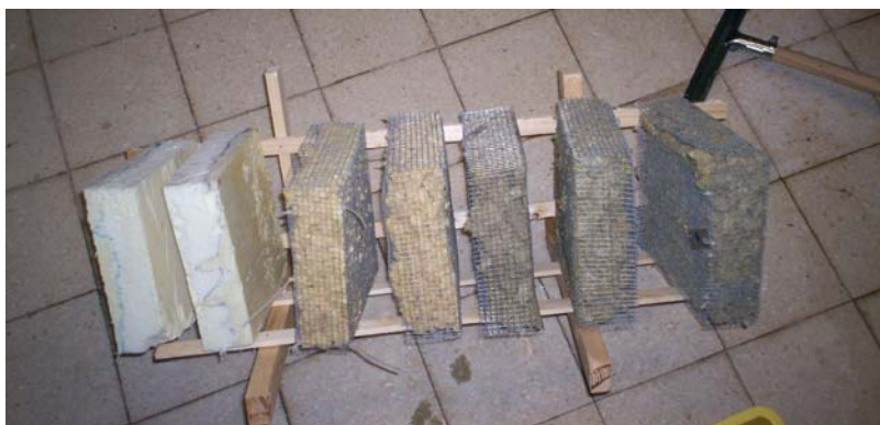
Figuur 12: Uitlekken van de proefstukken na de wateropnametest. De vezelvormige isolatiematerialen werden gevat in een bekisting van metaaldraad.
