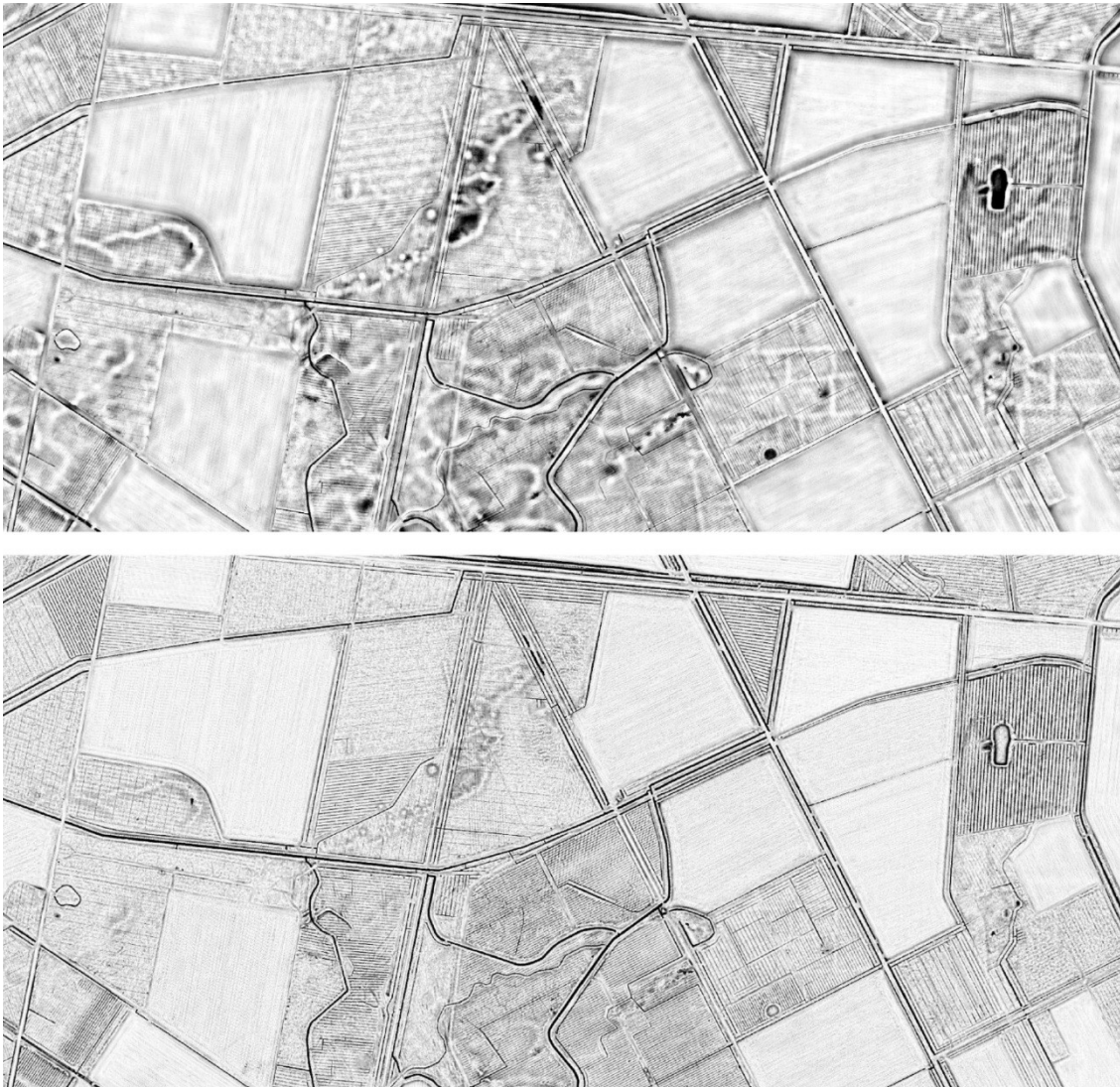
FIG. 12: De invloed van de 'zoekradius' bij de toepassing van skyview factor analyse. Boven: zoekradius 20 pixels. Onder: zoekradius 5 pixels.
