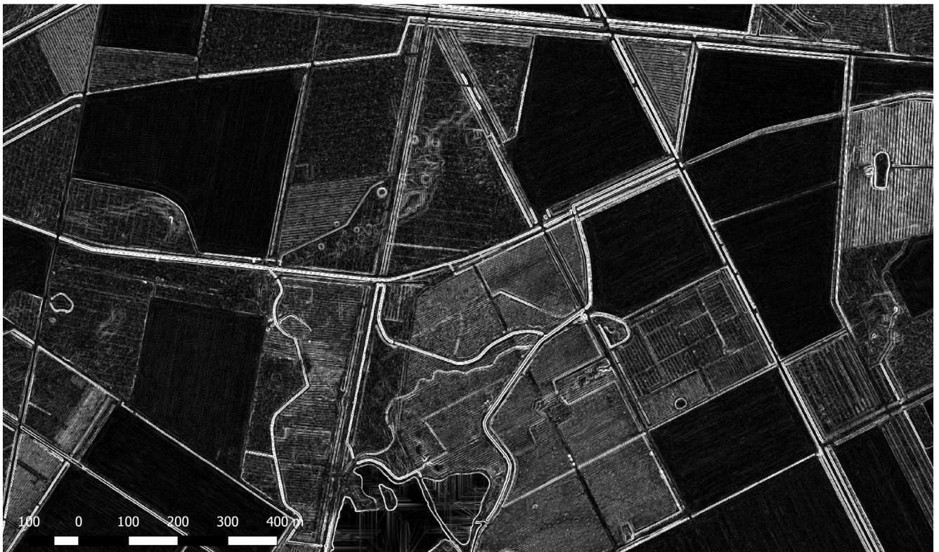
FIG. 13: Voorbeeld van een hellings- (slope) analyse.
